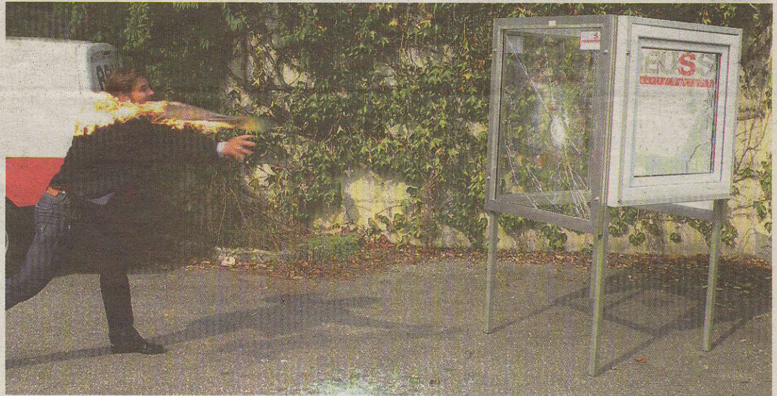
Mit einer Sicherheitsfolie und einer Stangenverriegelung nachgerüstete Fenster bieten einen effektiven Schutz gegen Angriffe mit Schlagwerkzeugen, Wurfgeschossen und auch Brandsätzen.
